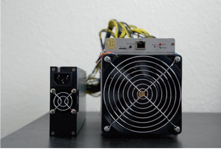
شكل ٤-٣: جهاز تعدين البتكوين «أنماينر» من طراز «إس ٩» بمعدّل تجزئة ١٣,٥ تيرا هاش في الثانية.
