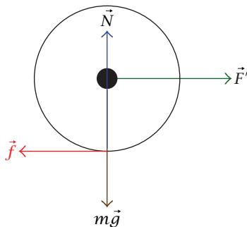
شكل ٢٢-٨: القوى المؤثرة على إحدى عجلات العربة.  $\vec{F}'$  هي القوة الأفقية التي يبذلها المحور، و $\vec{N}$  هي مجموع القوى الرأسية التي تبذلها الأرض على المحور.
