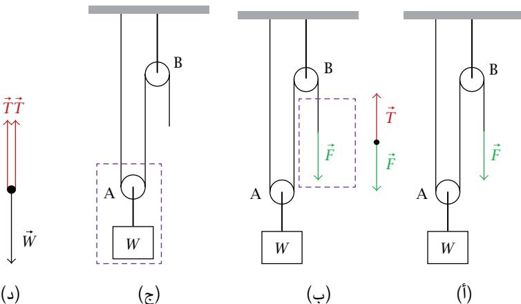
شكل ١١-٢: (أ) نظام بكرات بسيط في المثال ٧-٢. (ب) يبين اعتبار مخطط الجسم الحر للنظام المحاط بالصندوق المقطعي أن الشد في الحبل يكون مساوياً للقوة  $\vec{F}$  المؤثرة عند الطرف. (ج) من المفيد لحساب  $F$  أن نُعرّف نظامنا بأنه محتويات الصندوق المقطعي. (د) مخطط الجسم الحر للنظام المعروض في شكل ١١-٢(ج).
