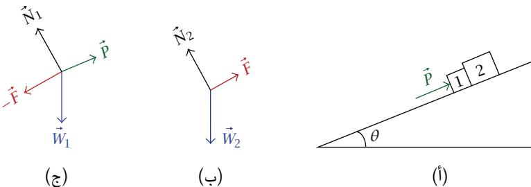
شكل ٧-٢: رسم توضيحي للمثال ٥-٢. كتلتان موضوعتان في حالة اتزان بواسطة قوة  $\vec{P}$  مؤثرة في اتجاه موازٍ للمنحدر. يبين شكل (ب). مخطط الجسم الحر للكتلة رقم ٢، بينما يبين شكل (ج). مخطط الجسم الحر للكتلة رقم ١.
