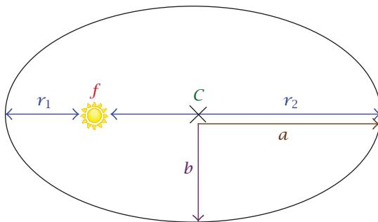
شكل ٤-٩: بارامترات مدار قطع ناقص مع بارامترات مقيسة من نقطة الأصل عند مركز القطع الناقص  $C$ : نصف المحور الأكبر  $a$ ، ونصف المحور الأصغر  $b$ ، والشمس عند نقطة البؤرة  $f$ . يقاس أقرب وأكبر مسافتين  $r_1$  و $r_2$  على الترتيب من  $f$ .
