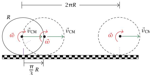
شكل ١٧-٨: جسم دائري نصف قطره  $R$  يتدرج بدون انزلاق على سطح أفقى، السرعة الزاوية هي  $\vec{\omega}$  ومقدار سرعة مركز الكتلة هو  $v_{CM} = \omega R$ .
