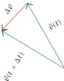
شكل ١١-١: إنشاء هندسي لتغيير السرعة لحركة دائيرية ذات مقدار سرعة ثابت.
