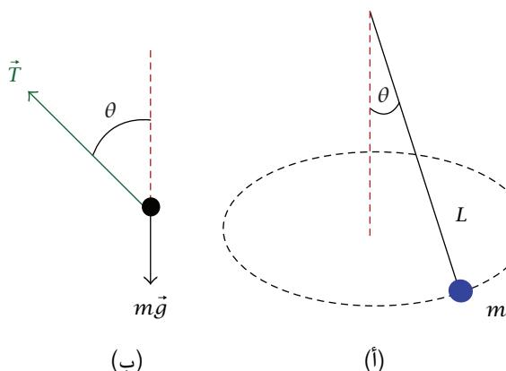
شكل ١١-٣: رسم توضيحي (أ) ومخيط الجسم الحر (ب) للمثال ١٢-٣
