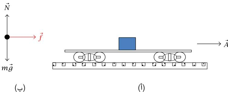
شكل ٨-٣: رسم توضيحي (أ) ومخيط الجسم الحر (ب) للمثال ٩-٣.
