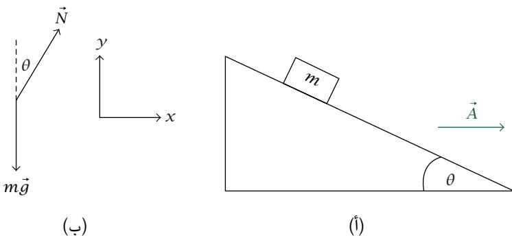
شكل ٢-٣: رسم توضيحي (أ) ومخيط الجسم الحر (ب) للمثال ٢-٣.
