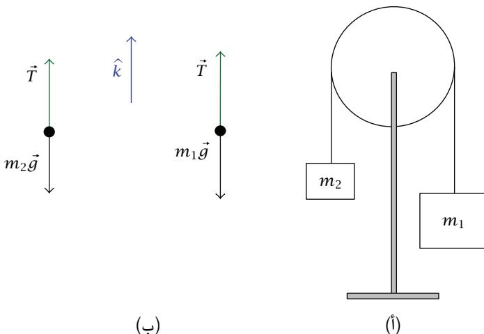
شكل ٣-٥: رسم توضيحي (أ) ومخيط الجسم الحر (ب) للمثال ٤-٣.
