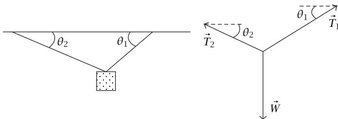
شكل ٦-٢: رسم توضيحي ومحاط الجسم الحر للمثال ٤-٦.
