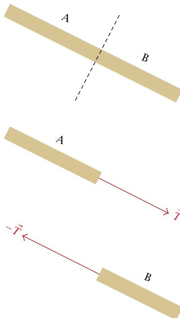
شكل ٩-٢: مفاهيمياً، نقسم الوتر إلى قطعتين بواسطة مستوى تخيلي. يؤثر B بقوة  $\vec{T}$  على A و يؤثر A بقوة  $-\vec{T}$  على B. المقدار المشترك لهاتين القوتين يُسمى الشد في هذه النقطة من الوتر.
